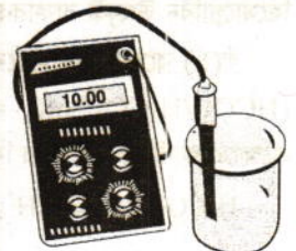
চিত্র-৪.২৮ : pH মিটার দ্বারা বাফার দ্রবণের pH পরীক্ষা।
